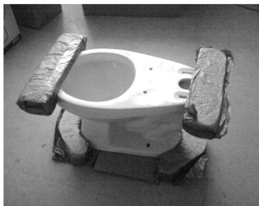
图7 现场发泡材料包装后的卫生洁具
