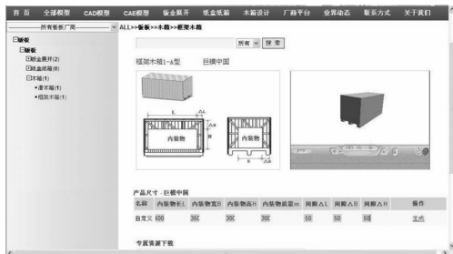
b 框架木箱的二、三维视图及参数表
