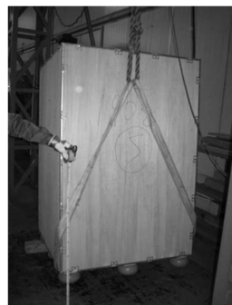
图 6 包装件的跌落测试 Fig. 6 Drop test of packaging
