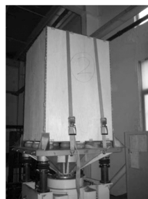
图 4 包装件的随机振动测试 Fig. 4 Random vibration test of package
