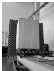
图 5 包装件的斜面冲击测试 Fig. 5 Inclined impact test of packaging
