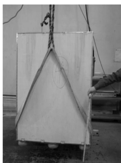
图 6 包装件的跌落测试 Fig. 6 Drop test of packaging
