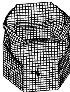
图6 蜂窝结构的压缩变形
