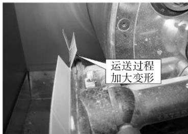
图4 商标纸输送过程中的变形
