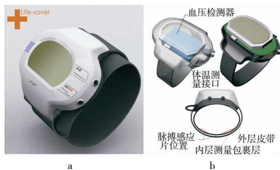
图5 生命体征监测腕表外观与结构设计
