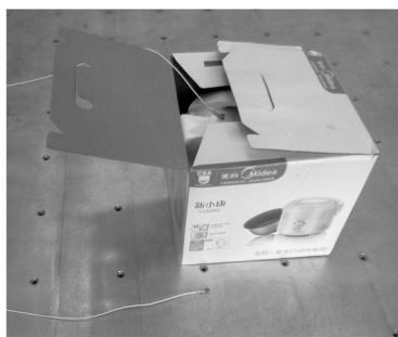
图1 整体包装定频振动试验
