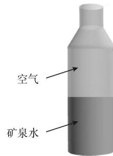
图3 饮料瓶的有限元模型
