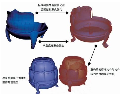
图5 原有香薰机的机身数据被分割后的独立构件数据和底座模型数据
