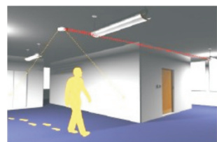
图3 红外感应控制 Fig.3 Infrared induction control
