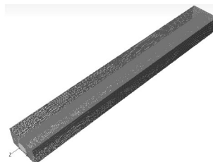
图3 风嘴网格划分 Fig.3 Meshing of nozzle
