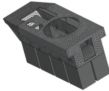
图2 着陆缓冲系统有限元模型
