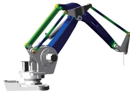
图5 码垛机器人柔性体模型
