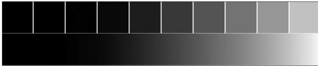
图4 渐变梯尺测试图
