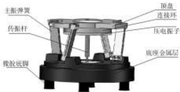
图1 螺旋式压电振动给料器结构
