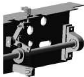
图1 铝箔卷装盒机封口机构
