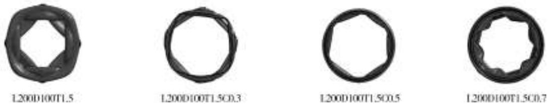
图7 不同刻槽深度模型压溃模式
