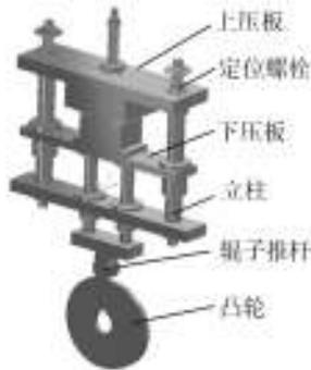
图1 罩边机构三维模型
