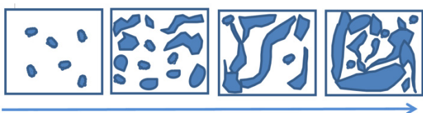
图1 导电填料逐步构建三维导电网络
