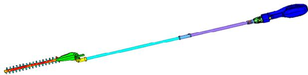
图 4 修枝机有限元模型
