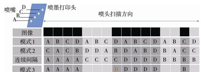
图 2 不同打印模式喷嘴工作顺序排布
