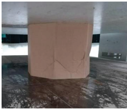
图 6 多边形瓦楞纸箱受压失效
