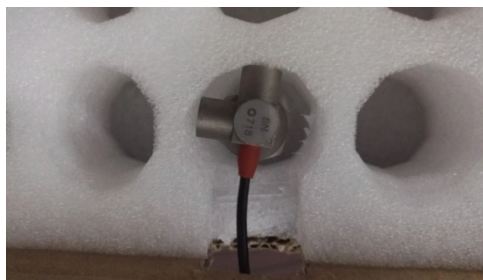
图4 加速度计的固定 Fig.4 Accelerometer fixation
