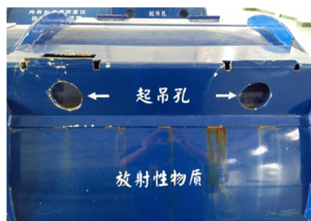
a 防腐层损伤
