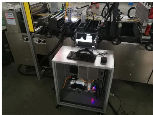
图 5 视觉系统硬件平台
