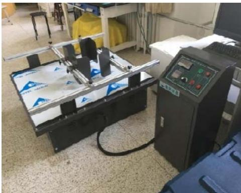
图 3 模拟运输试验台
