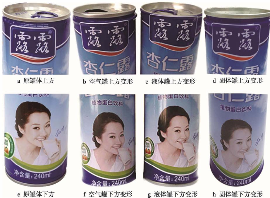
图 4 静压后的罐体与原罐体
