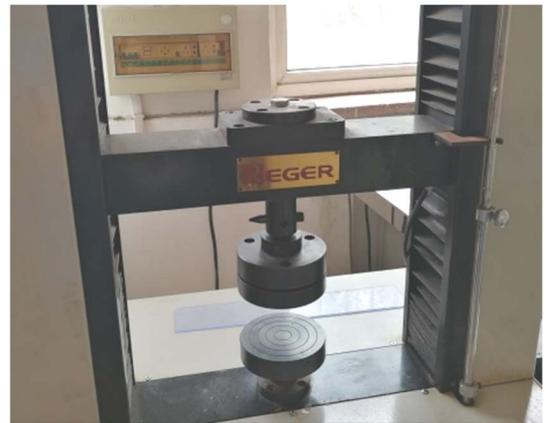
图 1 静态压缩实验设备
