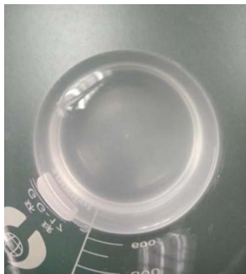
图 4 0.5 g 样品溶于 500 g 水中 1 h 后的结果 Fig.4 Result of 0.5 g sample dissolved to 500 g water after 1 h
