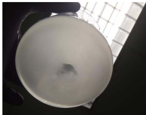
图 2 0.5 g 样品溶于 50 g 水中溶解 1 h 后的结果 Fig.2 Result of 0.5 g sample dissolved to 50 g water after 1 h
