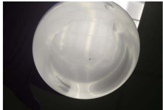
图 11 0.5 g 样品溶于 300 g 水中 1 h 后的结果 Fig.11 Result of 0.5 g sample dissolved to 300 g water after 1 h
