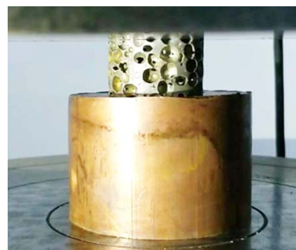
图3 泡沫铝准静态压缩实验
