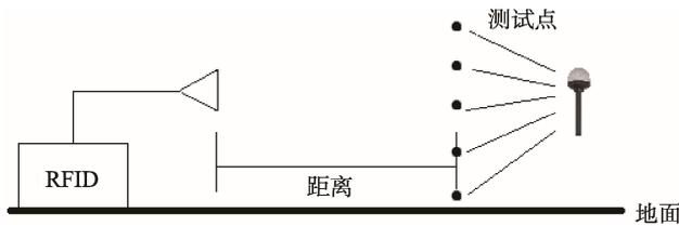
图7 RFID设备的电磁特性测量机位布置
