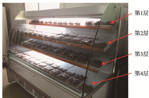
图 2 敞开式陈列柜货物陈列方式 Fig.2 Loading pattern of open display cabinet
