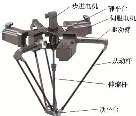
图 1 机器人基本结构
