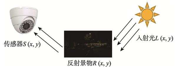
图 1 Retinex 模型假设的图像信号构成
