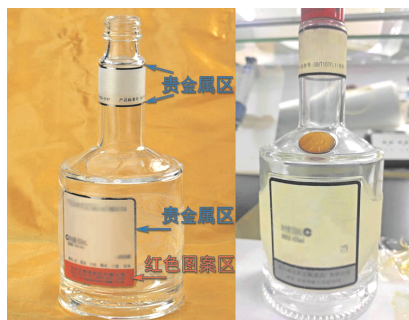
a 原始烤标瓶 b \text{NO}_x 腐蚀测试后
