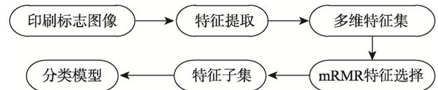
图 2 基于 mRMR 特征选择的印刷套准识别流程
