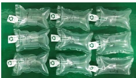
图1 枕型空气衬垫模型
