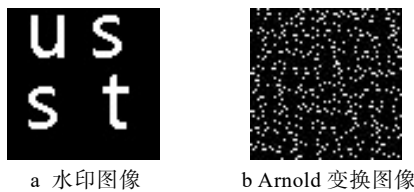
图 1 水印图像和 Arnold 变换图像 Fig.1 Watermark image and Arnold transform image
