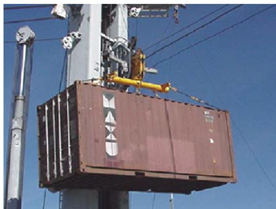
图3 20英尺集装箱海上补给试验
