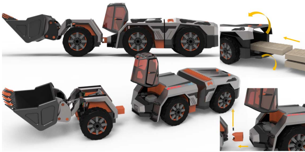
图 15 电池设计与组装方式 Fig.15 The battery design and assembly
