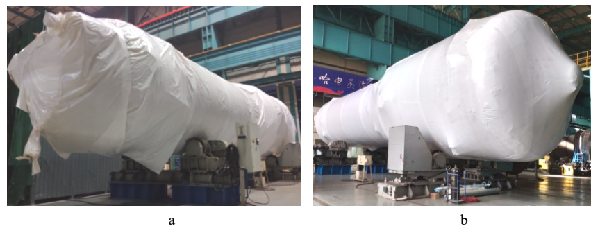
图 2 气相防锈热收缩包装后的核一级设备
