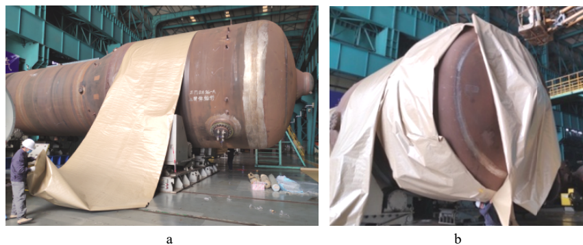
图 1 采用气相防锈纸对核一级设备的包装过程
