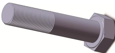
图 8 承重螺栓三维模型
