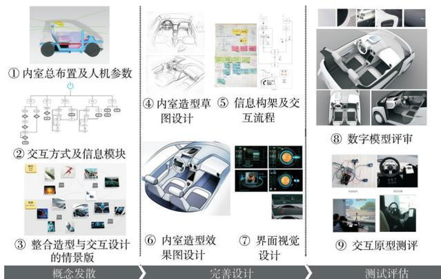
图3 电动车人机界面设计流程
