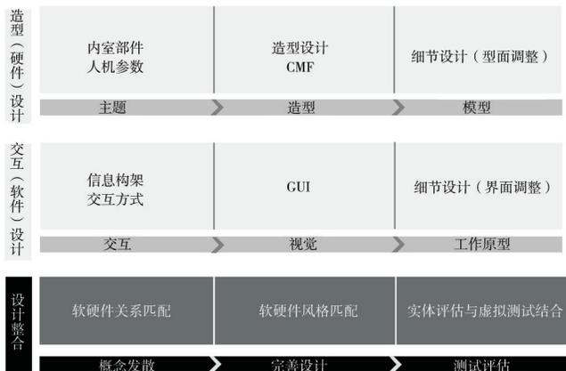
图2 造型(硬件)与交互(软件)设计的流程整合框架
