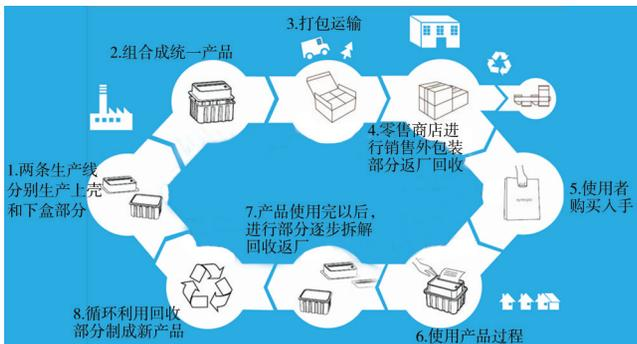
图3 纸浆模塑产品生命周期循环图
