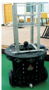
图4 机器人底座及支架结构
