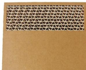
图4 立式瓦楞纸板
