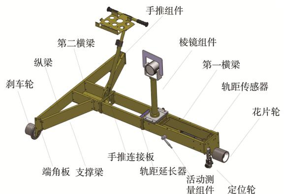
图 2 轨检小车结构
