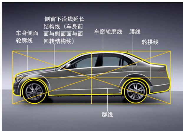
图 1 奔驰 C 系轿车侧脸线型及提取分析
