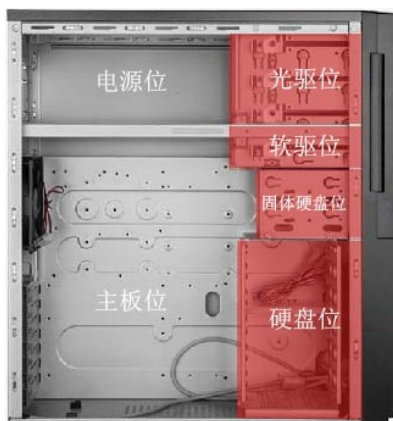
图1 传统机箱的空间分配 Fig.1 Cabinet space allocation
