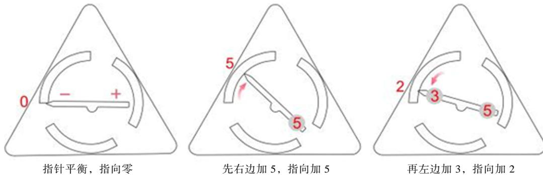
图 7 三角算盘的操作原理
