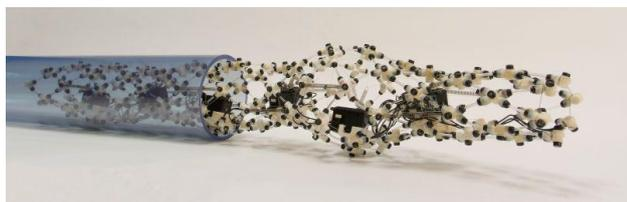
图 10 德国 Case Western 大学设计的蠕虫机器人
